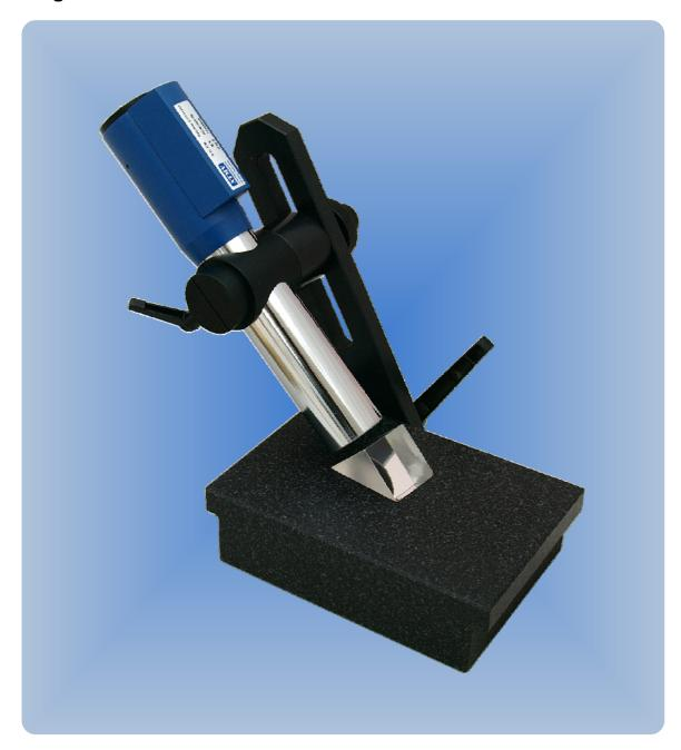
新的AngleMAT小型光电测角仪是一台高性价比的比较式测角仪产品,该产品由光电自准直平行光管、底座、支臂和选配的附件等组成。支臂可在允许范围内任意调整,结合专用的测量仪软件,可对各类棱镜、平晶、窗口等平面光学元件进行角度测量。
