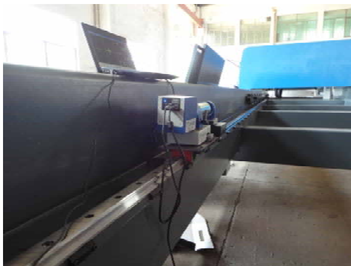
AutoMAT产品用于大型激光加工设备长导轨直线度测量
